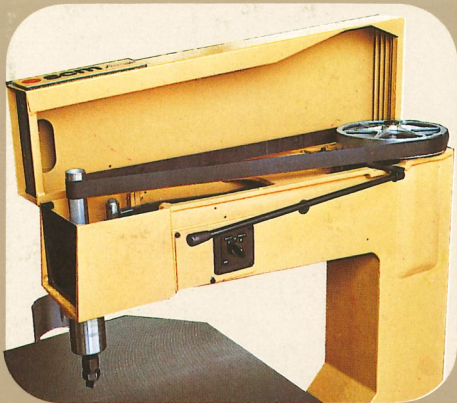
Detailfoto der Riemenkraftübertragung.
