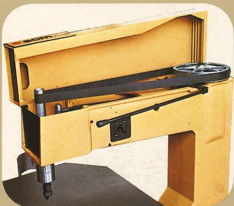
Particolare del sistema di trasmissione
