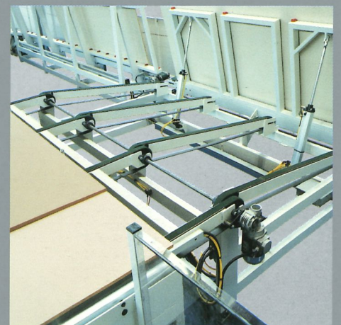
Rücklauf der Stützplatten auf der Rückseite.
