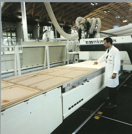
Umkehr des Vakuumstroms: die Platten werden auf einem Luftkissen vorgeschoben und ausgestoßen.
