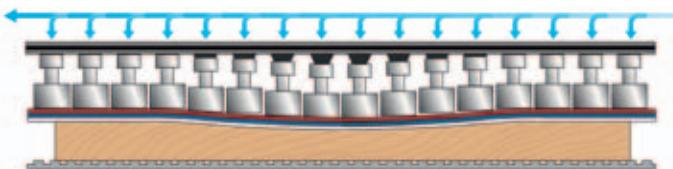
**Tampone elastico sezionato MESAR e on/off pneumatico dei rulli:** la migliore finitura con qualsiasi materiale.
