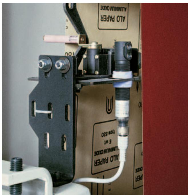
**Sistema elettronico di oscillazione** per la massima precisione nella traslazione dei nastri.
