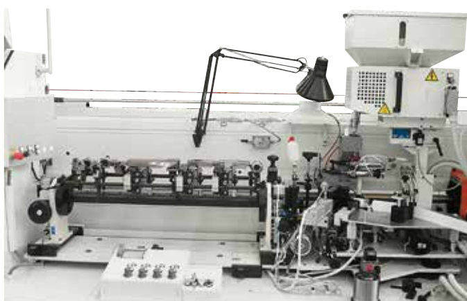
Verleimungsaggregat für die Bearbeitung von Türen mit dünnen/weichen Kanten.
