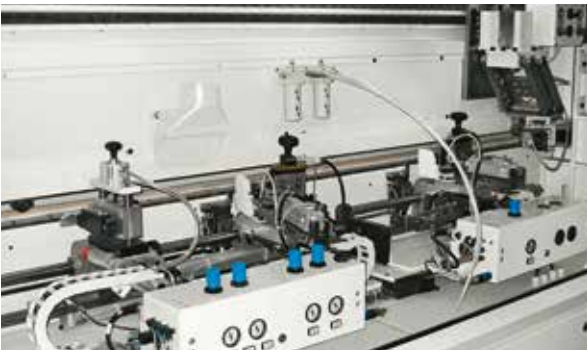
Aggregate für die Feinbearbeitung des Winkels in Türen mit Kantenanbringung auf 3 oder 4 Seiten.
