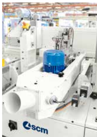
Schleifaggregate für die Endbearbeitung der mit Furnierkanten versehenen Türen.
