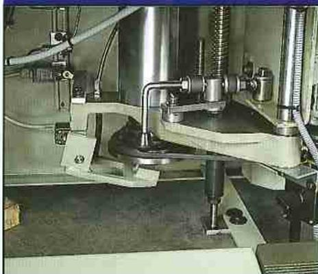
Mikroschalter an der Spindel und Mikroschalter für Öffnungsfreigabe der Tür.
