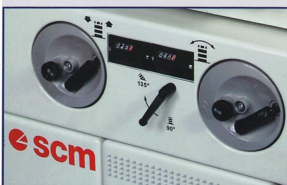
Il posizionamento dell'albero rispetto al piano di lavoro avviene manualmente mediante volantini posizionati sul fronte macchina. I lettori digitali meccanici garantiscono il raggiungimento di una precisione al decimo di millimetro sui posizionamenti riducendo notevolmente i passaggi di prova.
