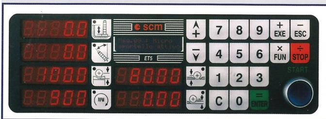
Easy: controllo elettronico fino a 6 assi per la gestione automatica integrata delle funzioni
