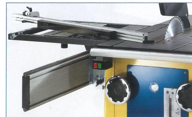
Die ts 4020 mit dem optionalen Schiebeschlitten in der Standardausführung mit ausziehbarer Anschlagschiene und Klapp-Anschlag.
