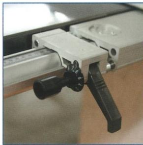
Die Feineinstellung des Längsschlag ist bei der ts 4020 serienmäßig, so können Sie im 1/10-mm-Bereich arbeiten
