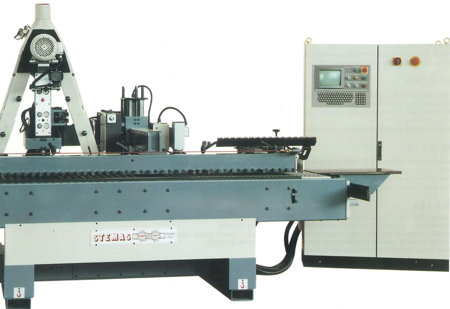
LEV. T.S.B. con aggiunta di piano supplementare e sistema di traino per levigatura di bordi pannelli con lati diritti.
