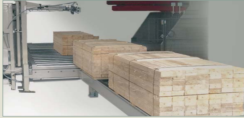
Beispiel für einen automatischen Pakettransport mit Bündelung der Pakete. Damit ergibt sich ein minimaler Zeitaufwand für Paketwechsel, sodass sich die Leistung der Anlage erhöht.
