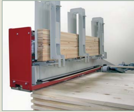
Leistenmagazine für die Abgabe von Leisten, um die Pakete zu stabilisieren.
