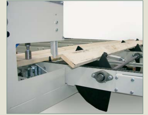
Wenn die Werkstücke vor dem Stapeln oder zum Weitertransport gewendet werden sollen, kann ein Werkstückwender wie hier dargestellt einbezogen werden.
