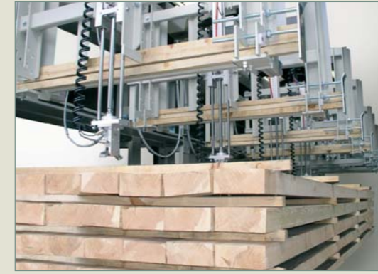
Leistenmagazine für die Abgabe von Leisten an die Trockenkammer oder zum Stabilisieren der Pakete.
