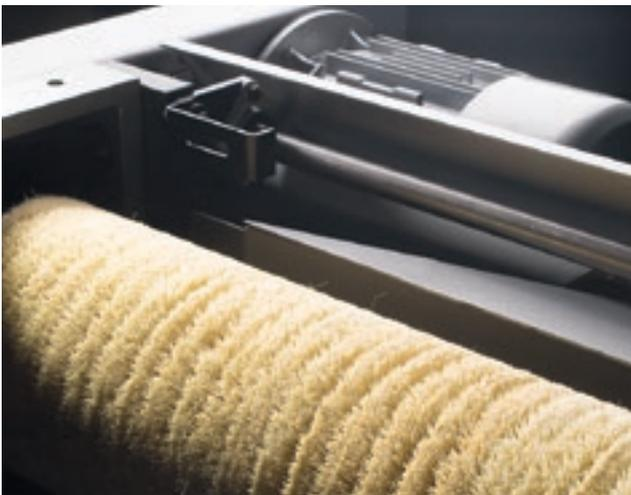
El **cepillo de limpieza del tablero** puede ir dotado de cerdas de varios materiales para limpiar profundamente los tableros mecanizados.
