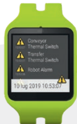
AVISOS Lista de alarmas o solicitudes de mantenimiento. Cada vez que la máquina informa de un problema o una solicitud de mantenimiento, el reloj Viet Watch vibra y aparece un icono de advertencia en la pantalla.
