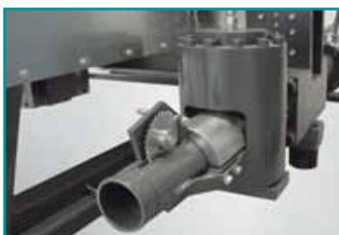
Procédé innovant qui va permettre le maintien permanent de la longueur des briquettes quelque soit le combustible.
