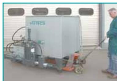
Les briqueteuses sont facilement transportables et peuvent être utilisées de façon mobile du fait de leur conception sur un châssis adapté.
