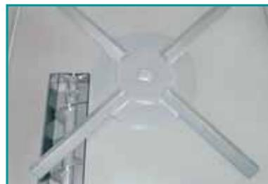
Malaxeur rotatif qui va mélanger la matière et l'entraîner sur la vis sans fin qui va l'acheminer de façon cyclique jusqu'au mécanisme de presse.
