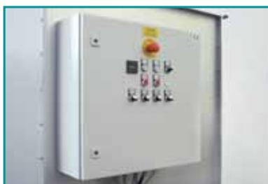
Armoire électrique automate programmable permettant un usage aisé de la briqueteuse et un réglage facile pour l'utilisateur.
