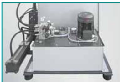
De hydrauliektank is separaat geplaatst. Daardoor wordt de optredende opwarming van de olie optimaal afgevoerd. De goede toegankelijkheid maakt het mogelijk dat onderhoudswerkzaamheden servicevriendelijk uitgevoerd kunnen worden.
