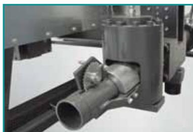
Met de briketlengte - automaat kan de lengte van de briquettes ook bij verschillende materialen constant gehouden worden.
