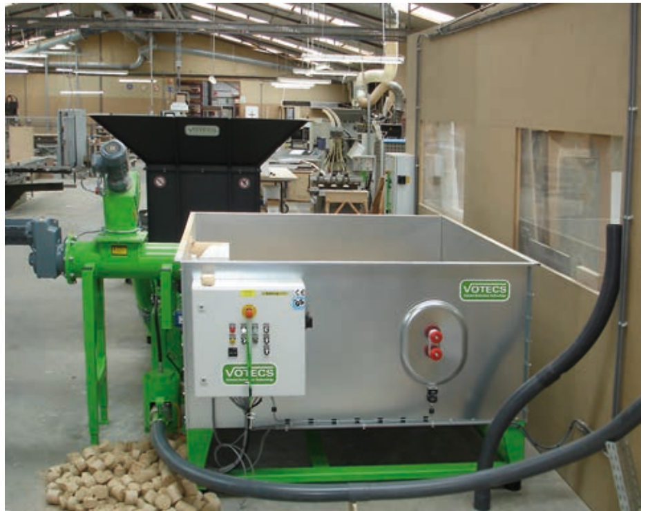
In Abhängigkeit vom Material sind mit der Brikettierpresse „AP 775“ Stundenleistungen von 120 bis 160 kg möglich.
