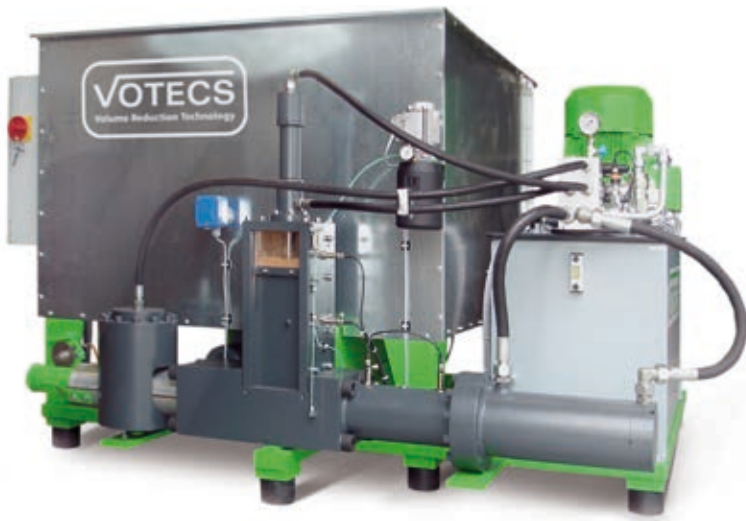
Brikettierpresse AP 775 mit 150 kg/h Durchsatzleistung, 70 mm Brikettdurchmesser
