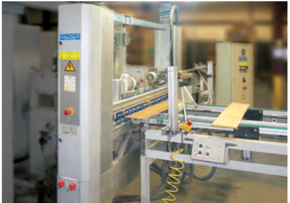
Beidseitige Reinigung von schmalen Paneelen mit Cleaner CF 05..
