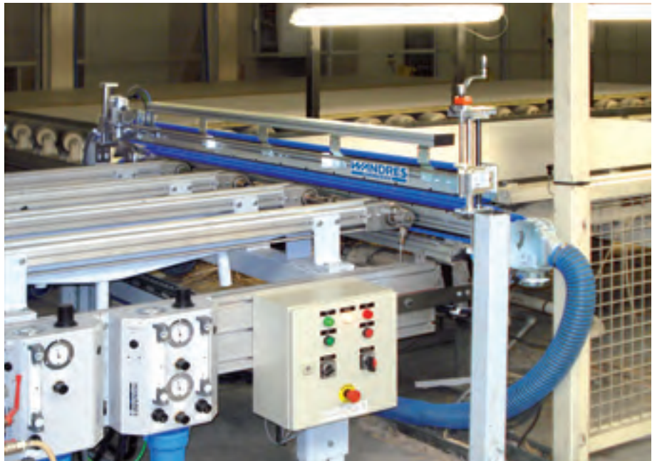
Beidseitige Reinigung von Spanplatten vor Inspektionsplatz
