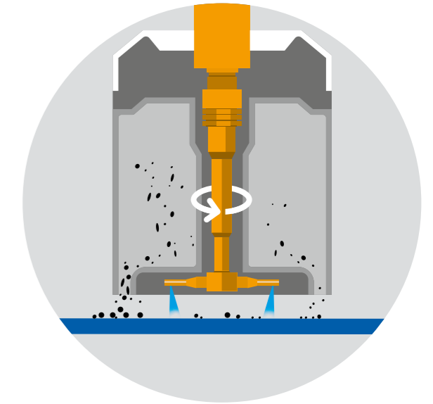
3 Tornado-Channel mit Tornadodüsen
