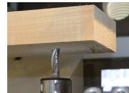
Zapfenloch-Fräsung mit Unterfluraggregat
