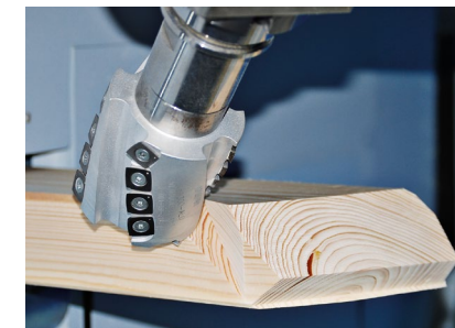
Herstellen eines Zapfen
