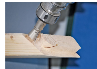
Schwabenschwanz am Schifter
