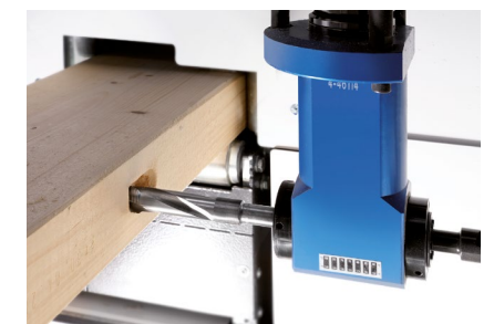
Producción de mortajas y escotaduras
