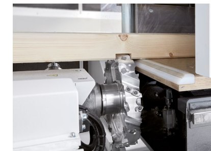
Entalladuras con fresa de disco
