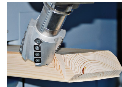
Creación de un bulón
