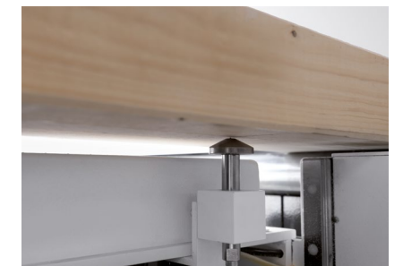
Posibilidad de realizar marcas en el lado inferior de la pieza constructiva
