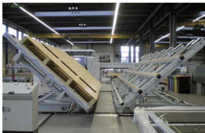
Das einseitig geschlossene Element wird mit Hilfe des Schmetterlingwenders gewendet After completion of the first element side the butterfly turning table turns the element
