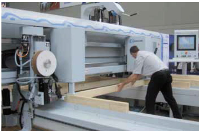
Automatisierte Riegelwerkserstellung / Automated framework generation
