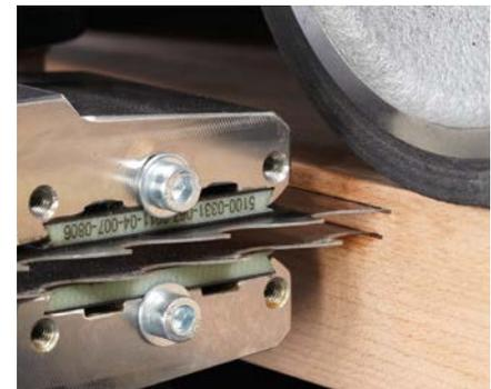
Guide lame à pression au carbone extrêmement résistant à l'usure
