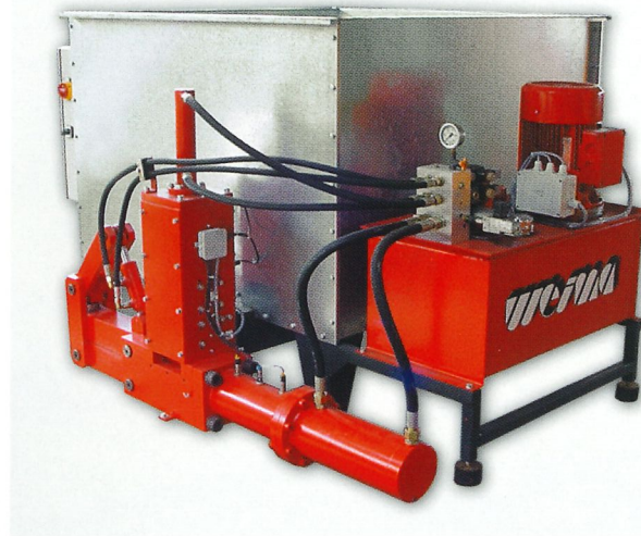
Brikettierpresse der Baureihe TH 400 - TH 700, Behältergröße 1.400 x 1.400 x 1.250 mm
