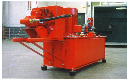
Ölkühlung für Hydraulikaggregat (optional)
