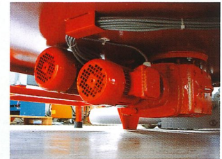
Brikettierpresse der Baureihe TH 400 - TH 700, Behältergröße 1.400 x 1.400 x 1.250 mm
