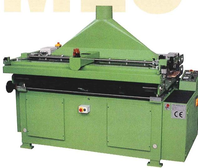
Le Sezionatrici Multilame per pannelli con trasporto a rulli, realizzate in varie potenze e larghezze da 80 a 190 cm, sono macchine ad alto rendimento utilizzate con ottimi risultati per tagli e fresature multiple su pannelli, parquet prefinito, pareti e ante, strisce per profili, battiscopa, doghe per letti, cornici in MDF, ecc.
