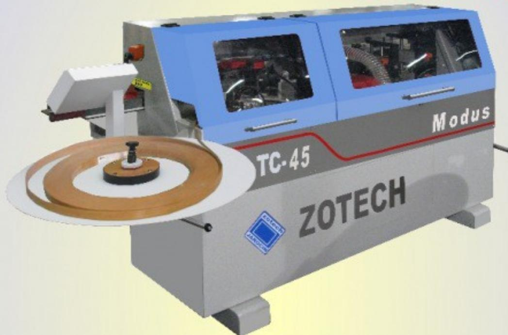
**Oklejarka TC-45 Modus** jest kompaktową maszyną przeznaczoną do jednostronnego, prostoliniowego oklejania obrzeżem typu PCV i ABS, papierowym oraz naturalnym w rolce lub paskach z jednoczesną obróbką nadmiaru z długości oraz grubości formatki.
