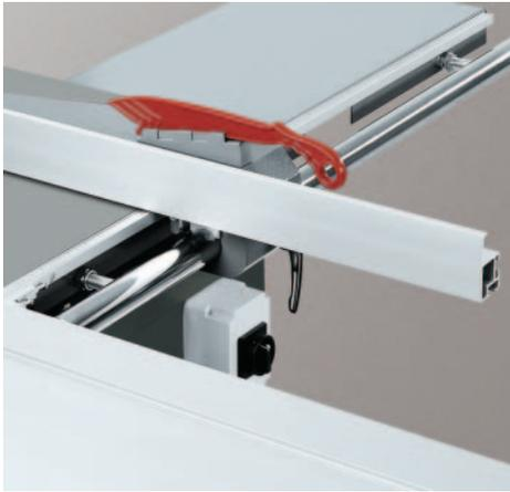
Der Parallelanschlag: leichtgängig und präzise verstellbar.
