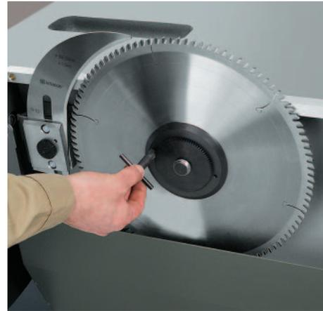
Schneller, komfortabler Sägeblattwechsel durch das Schnellspann-System.
