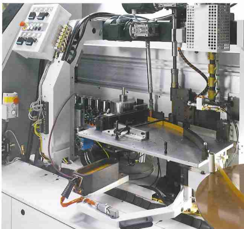
Système breveté High-Melt avec extraction frontale du bac colle.
