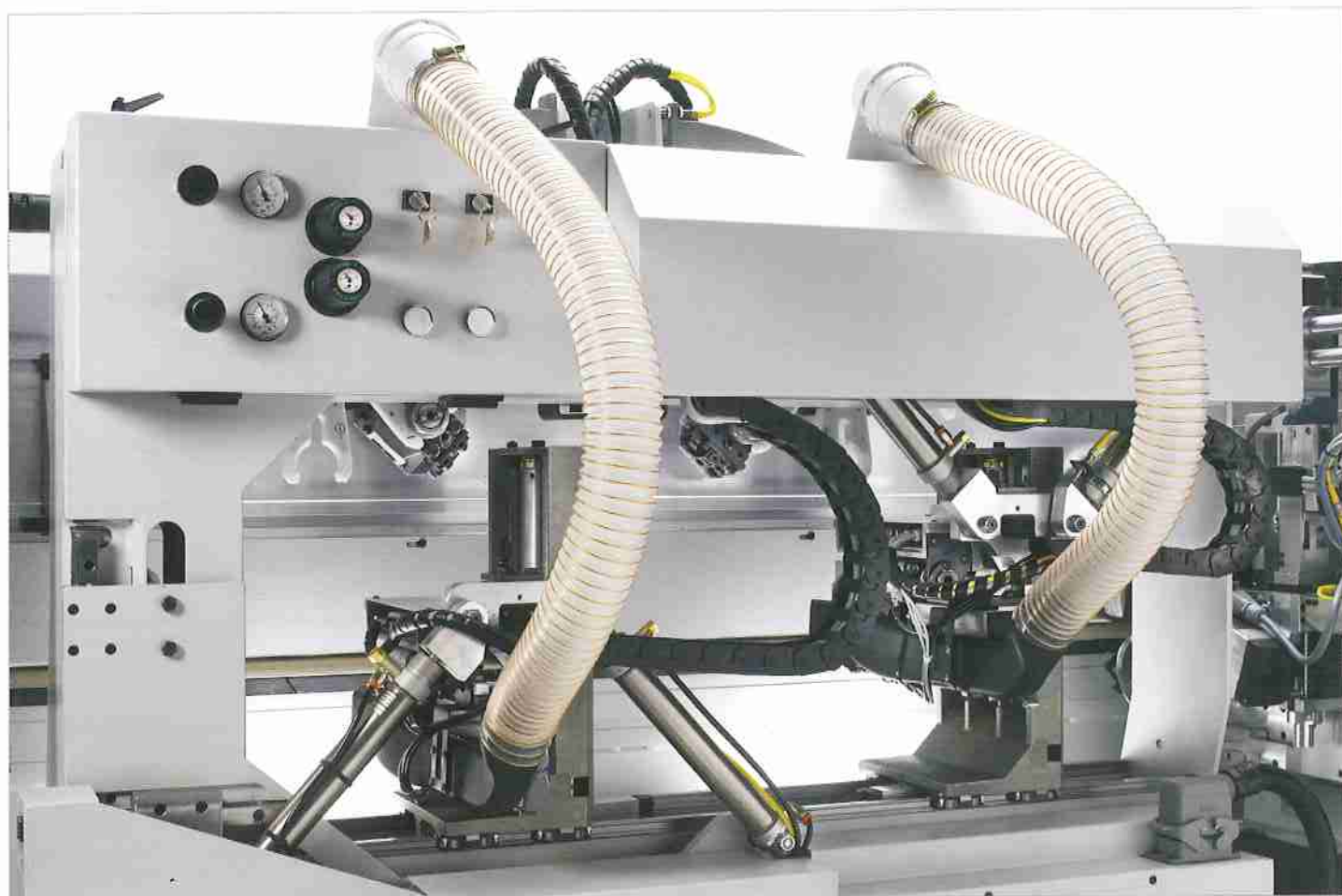
AR60 - Groupe arrondisseurs multifonctions à 2 électrobroches avec changement automatique de l'outil.
