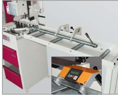
Rollenbahn mit Messeinrichtung Analog oder mit Digitalanzeige und Feineinstellung
