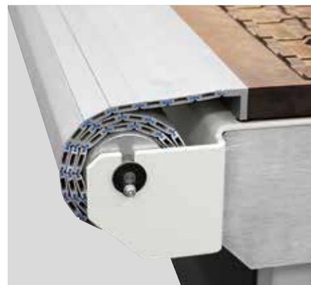
Dispositivo antintrusione avvolgibile (opzionale). Roller shutter intrusion detection device (optional). Dispositivo anti intrusión por medio de cierre metálico (opcional).
