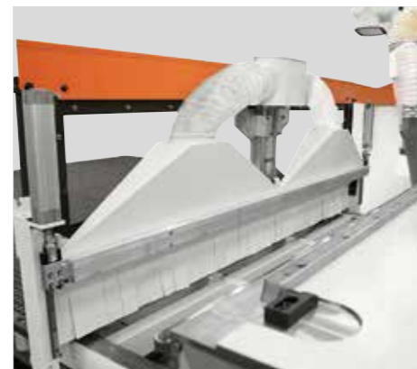
Dispositivo di scarico con aspirazione integrata (opzionale). Unloading device with integrated suction system (optional). Dispositivo de descarga con aspiración integrada (opcional).
