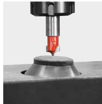
Dispositivo pre-setting lunghezza utensile (opzionale). Tool length presetting device (optional). Dispositivo de pre-setting longitudud herramienta (opcional).
