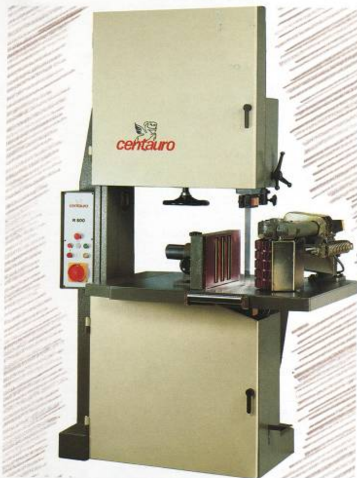
R800 equipaggiata di refendino RA210. R800 équipée du dedoubleur RA210. R800 fitted with RA210 feeder. R800 ausgerüstet mit Vorschubapparat RA210.
