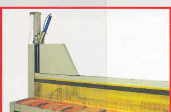
Unità laser per la visualizzazione della linea di taglio e lo sfruttamento ottimale del materiale da segare (opzionale)
