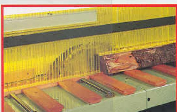
Particolare della protezione a ponte. La trasparenza delle lamelle protettive in materiale antistatico e la loro robustezza garantiscono la massima sicurezza all'operatore.
