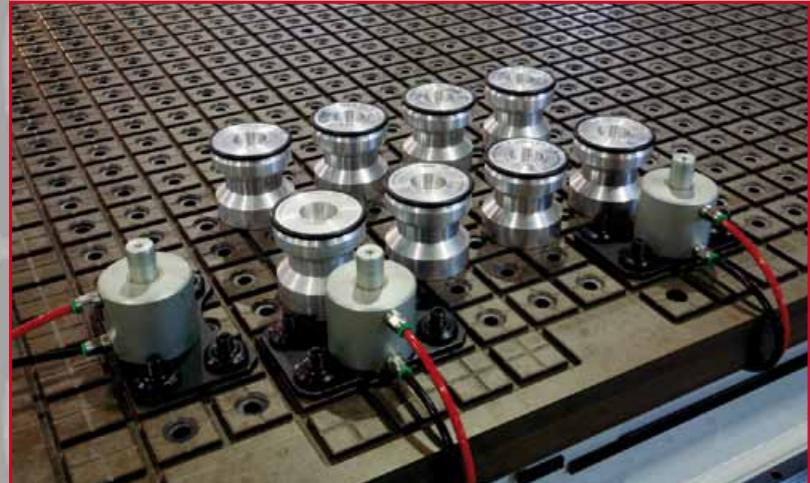
Esempio di posizionamento di ventose COSMEC ad innesto rapido e battute a scomparsa.
