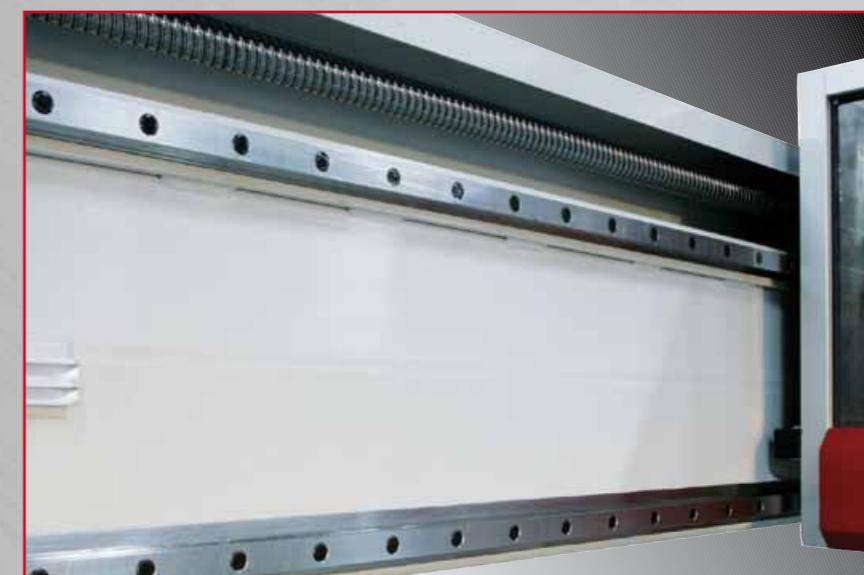
La movimentazione dell'asse Y, preservata da un accurato sistema di lubrificazione automatica, avviene tramite vite a ricircolo di sfere da 32 mm. di diametro con una velocità di avanzamento di oltre 60 m/min.
