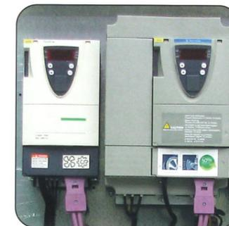
Elektronischer Frequenzumrichter für variable Schleifbandschnittgeschwindigkeiten von 1 bis 16 oder 20 m/s. Die niedrigen Schnittgeschwindigkeiten werden für das Fein- und Lackschleifen gewählt. Die hohen Schnittgeschwindigkeiten sind für größere Spanabnahmen.
