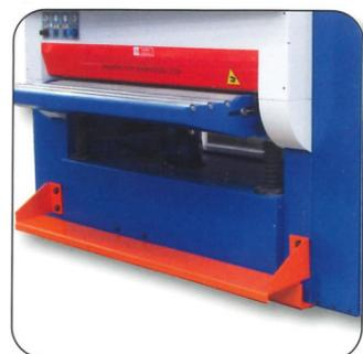
Optionale Transportelemente für Staplertransport vorne und hinten an der Maschine befestigt. (werden nach dem Transport entfernt und gelagert)
