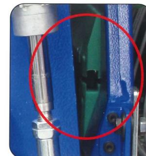
Oszillierende Ausblasdüsen (optional) zur Reinigung der Schleifbänder. Die Blasdüsen sind empfehlenswert beim Einsatz von feinen Schleifbandkörnungen und zwingend erforderlich für den Lackschliff. Sie verhindern ein Zusetzen der Schleifbänder mit Staub und verlängern die Standzeit und sorgen für ein besseres Schleifergebnis.
