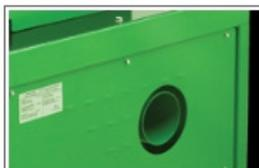
Absaugvorrichtung für Industriesauger (alle Modelle außer bei CP 333 NTi und CP 316 S2i)
