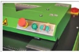
Bedienelemente und Not-Aus-Einrichtung bei der CP 422 S2
