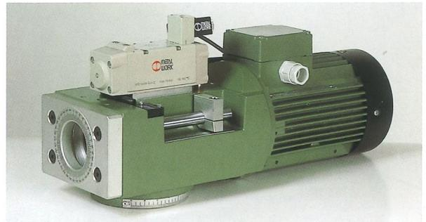
Bohrköpfen, standard: 1-, 3-, 5-, 7- und 9-Spindel mit Mitte bis Mitte 16, 17, 21, 22, 25, 27 oder 32 mm. Alle Bohrköpfe sind 360° um eingene Achse schwenkbar. Werkzeugaufnahme M8 Antriebs-Innengewinde. Der Austausch der Bohrköpfe ist einfach. Spezial-Bohrköpfe werden nach Aufgabe konstruiert.
