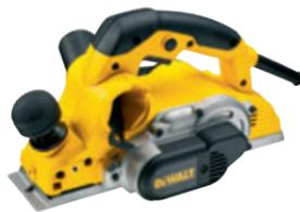
Hochleistungsmotor für beste Ergebnisse auch in hartem Holz. Spanauswurf rechts oder links einstellbar. Hobelstärke in 1/10 mm-Schritten schnell und präzise einstellbar. Plangefräste Hobelsohle mit 3 V-Nuten im Aufnahmeschuh zum einfachen und präzisen Anfasen.
