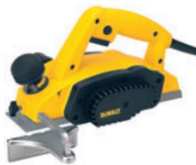
Geringes Gewicht und ausgewogene Gewichtsverteilung. Hobeltiefe über Zusatzhandgriff in 0,1 mm-Schritten schnell und präzise einstellbar. Hochleistungsmotor für beste Ergebnisse auch in hartem Holz. Plangefräste Hobelsohle mit 3 V-Nuten im Aufnahmeschuh zum einfachen und präzisen Anfasen.
