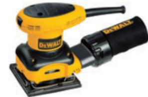
Leistungstarker Motor mit 230 Watt Aufnahmeleistung für hohe Schleifleistung bei allen Anwendungen. Hohe Lebensdauer durch speziellen Staubschutz von Schalter und Lager. Federgelagertes Ausgleichsgewicht reduziert wirkungsvoll Vibrationen. Schleifplatte mit Klettfix-Aufnahme sowie Klemmechanismus zur einfachen Befestigung von Standard-Schleifpapier.
