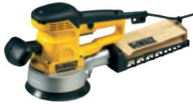
Wahlweise zwei verschiedene Schwingkreisdurchmesser für schnelles Vorschleifen (6 mm) oder feine Endbearbeitung (3 mm) einstellbar
