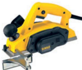
Geringes Gewicht und ausgewogene Gewichtsverteilung. Hobeltiefe über Zusatzhandgriff in 0,1 mm-Schritten schnell und präzise einstellbar. Große Messerwelle mit hoher Umlaufgeschwindigkeit für perfekte Oberflächenresultate. Plangefräste Hobelsohle mit 3 V-Nuten im Aufnahmeschuh zum einfachen und präzisen Anfasen.
