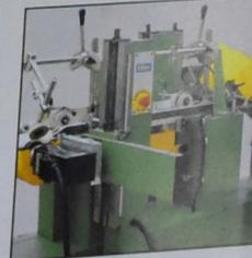
FR-Fräsggregat in verschiedenen Ausführungen für gerade Profile.
