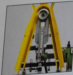
PS-Profilbandschleifaggregat mit elektronischer Schleifschuhsteuerung.
