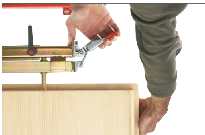
Rüsteisen am Schwenkarm befestigen
