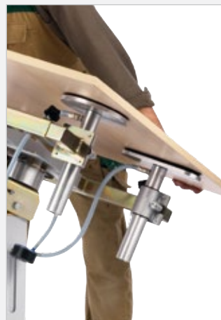
Halterung kann für kleine Werkstücke nach innen gewendet werden
