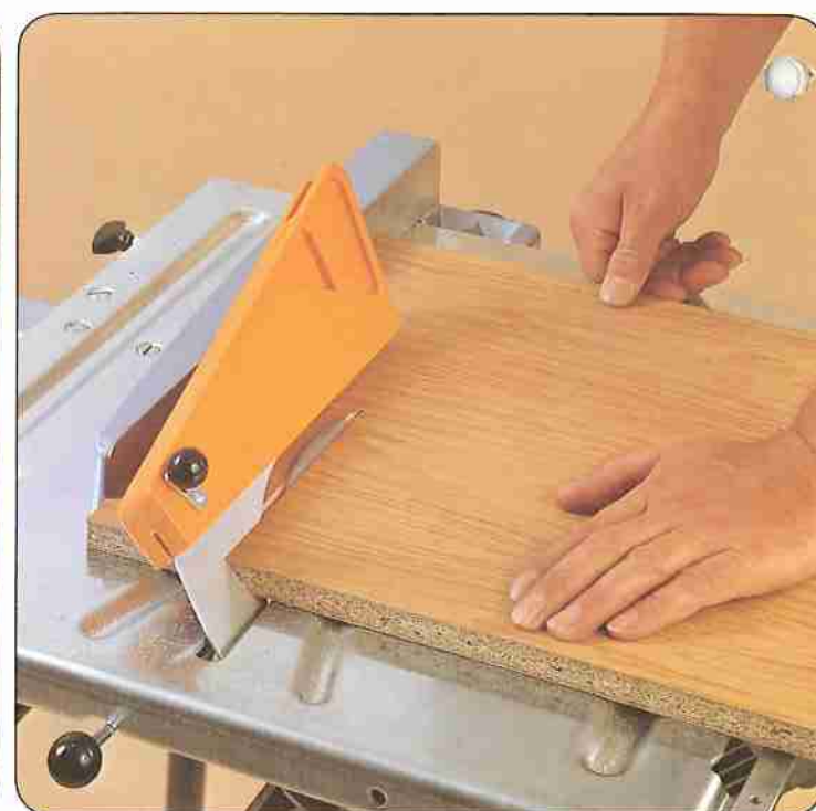
Passgenaue Winkelschnitte mit der TGS in Tischsägefunktion.
