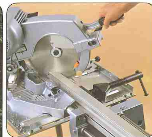
Präzise Schnitte auch bei Aluminiumprofilen.
