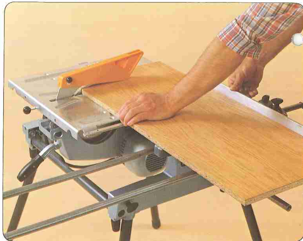
Anschlagsschiene in einer Nut fixierbar, dadurch garantiert rechtwinkelige Schnitte.
