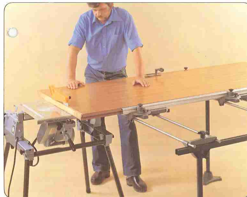
Die TGS mit dem Doppelschiebetisch für große Werkstücke: 1015 mm breite Auflagefläche.
