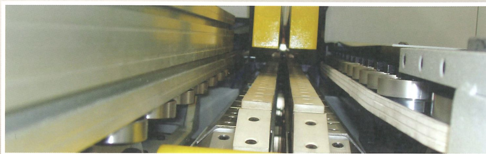
Автоматическая система центрирования заготовки с боковой регулируемой линейкой и ленточным приводным транспортером с противоположной стороны. Automatisches Zentrierungssystem am Einlauf der Längsbearbeitungsmaschine mit einstellbarem Seitenschnabel und gegenüberliegendem angetriebenem Druckriemen. Automatic infeed centering system with lateral adjustable fence and motorized opposite belt.
