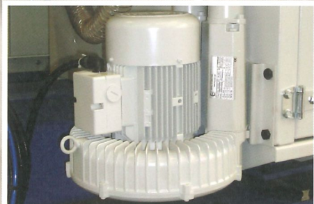
Цепной конвейер, оснащенный пневматической системой натяжения. Unterdrucksetzungspumpe der Vorschubkette. Feed chain assembly pressurizing pump.
