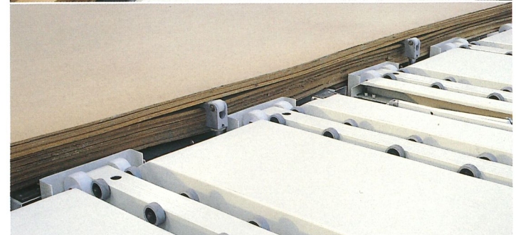
Carga de paneles finos Solución consolidada en el tiempo que, gracias a su simplicidad de fabricación, asegura una carga automática de paneles finos precisa y eficaz.
