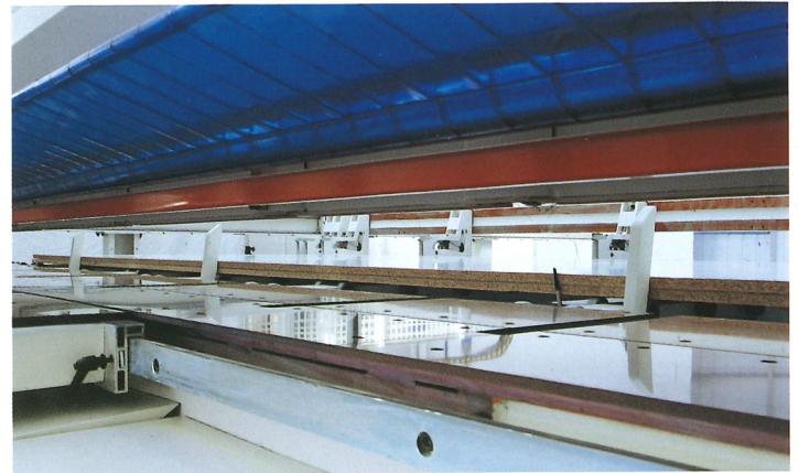
Allineatori frontali per il carico automatico Ausrichter für die automatische Ladung Alineadores frontales para la carga automatica
