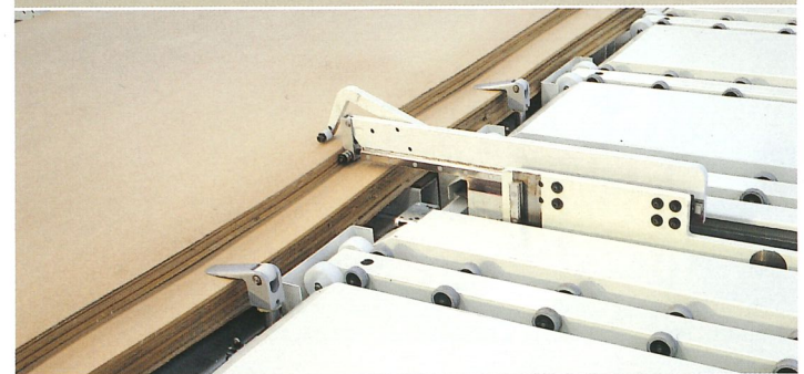
Carico pannelli sottili Soluzione consolidata nel tempo che grazie alla semplicità costruttiva assicura un caricamento in automatico di pannelli sottili preciso ed efficace.
