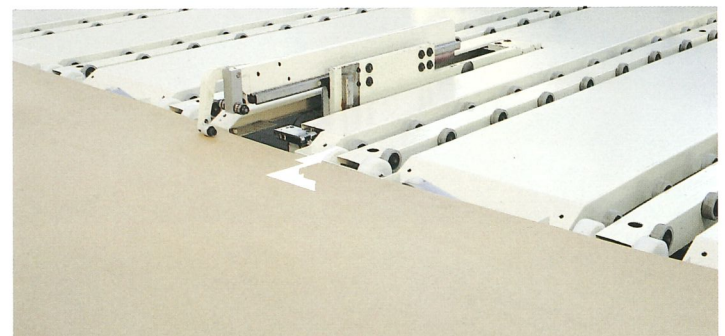
Allineatori frontali per il carico automatico Ausrichter für die automatische Ladung Alineadores frontales para la carga automatica
