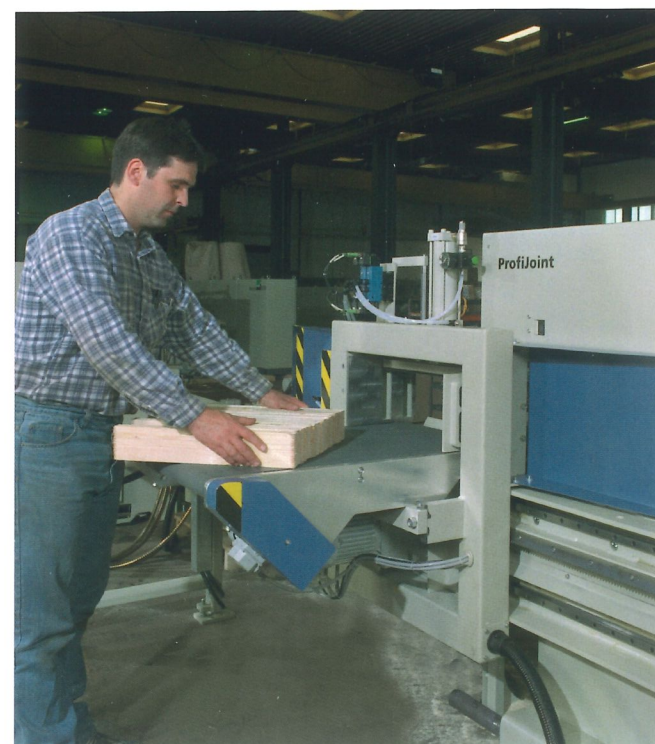
Tisch mit angetriebenem Band, frequenzgeregelter Tischvorschub
