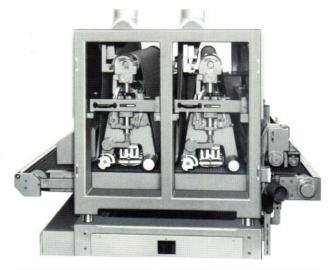
Um an Rahmenteilen und bei zusammengesetztem Längs-und Querfurnier in jedem Bereich im abschließenden Schleifvorgang einen Schliff in Faserrichtung auszuführen, kann ein Rahmenschleifprogramm integriert werden.
