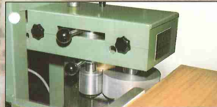
HESS-Leimangabemaschine für einseitigen, vertikalen Leimauftrag. Leimauftragungsgeschwindigkeit 45 m/min.
