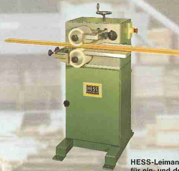
Wenn große Leistung und kurze Abbindezeiten gewünscht werden, ist die Anwärmung des Holzes vorteilhaft.
