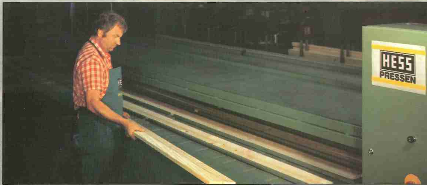
Wenn große Leistung und kurze Abbindezeiten gewünscht werden, ist die Anwärmung des Holzes vorteilhaft.
