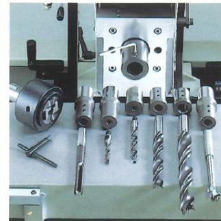
Spezialbohrfutter mit Werkzeug-Schnellwechselsystem - exakter Rundlauf
