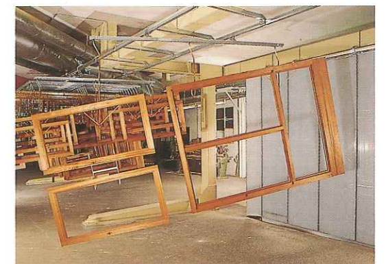
Ausgeklügelte Mechanik hilft den Platz für grundierete Rahmen zu minimieren.
