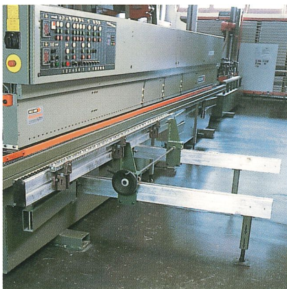
Gegendruckschiene zum Bearbeiten von Werkstücken mit emp- findlicher Oberfläche, die keinen starken An- preßdruck durch die Druckbrücke zulassen
