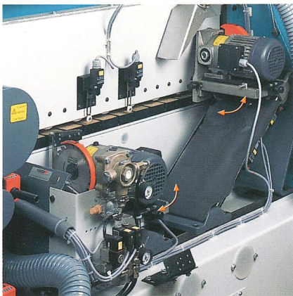
Kappen automatisch 10° schwenkbar vom Bedienerpult aus. Das Öffnen der Schutzhaube und Schwenken der beiden Kappsägen von Hand, beim Kappen der 3. und 4. Seite, erübrigt sich dadurch
