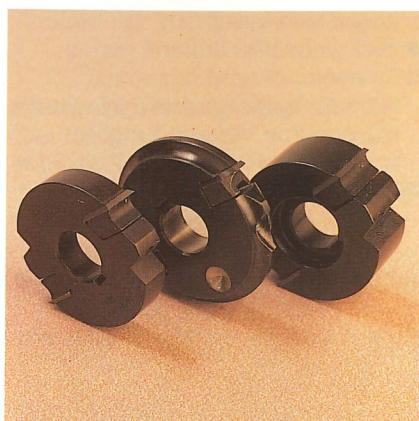
H.M.-Wendeplattenfräsköpfe zum Bündigfräsen, Fasen oder Radiusfräsen r = 2 mm bis r = 5 mm
