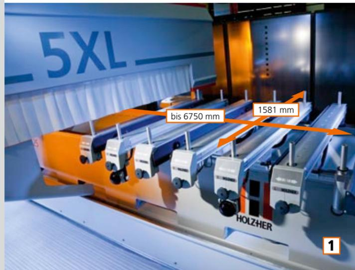
Das Grundgestell der Konsolenmaschine und die Fahrständer in Einarmausführung – beides als Schweißkonstruktion – garantieren eine überlegene Stabilität. Zusammen mit den geschliffenen und gehärteten Prismenführungen bildet dies die Basis für präzises Arbeiten. Der Zahnstangenantrieb in X- und Y-Richtung ist schräg verzahnt und garantiert höchste Präzision bei den hohen Beschleunigungen und Geschwindigkeiten.
