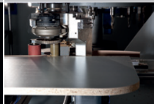
Verleimaggregat easyEdge zum rationellen Anleimen an Formteile
