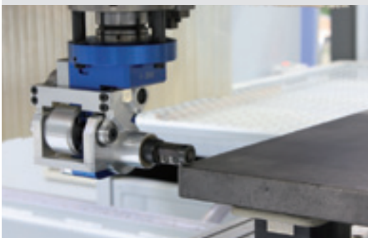
Getastetes Bündigfräsen der Kantenüberstände am Postformingprofil
