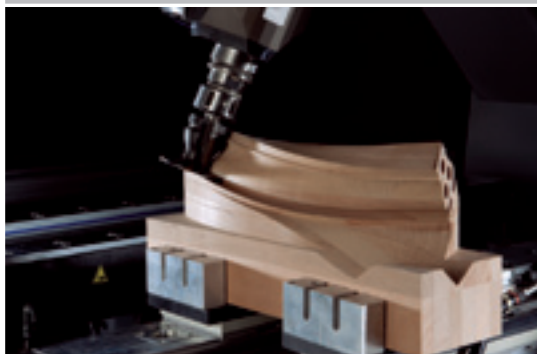
Fräsen eines Treppen-Handlaufs
