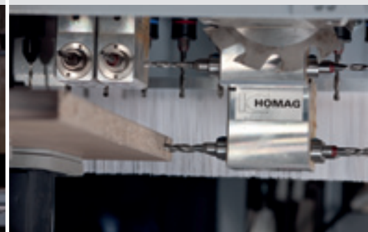
Horizontalbohrungen für Korpusverbindungen
