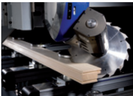
Exakte Schifterschnitte – passgenau auf Anrieb auch bei großen Materialstärken.
