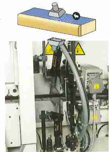
Aggregat zur Auffrischung der Kante. Edge brightening unit
